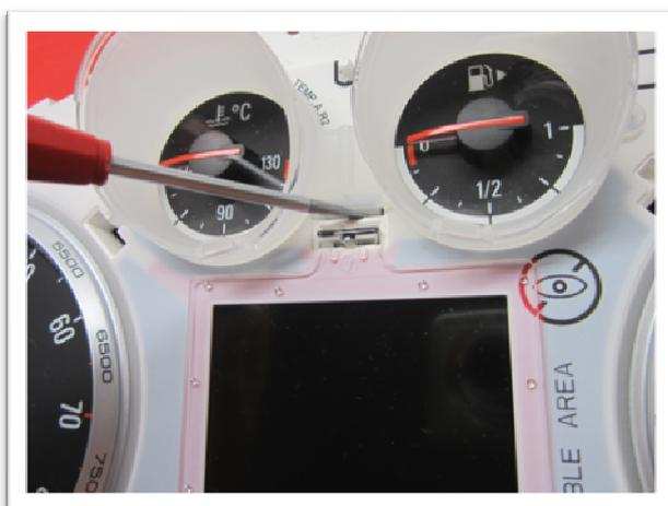
Einfach kurz mal einen Schlitzschraubendreher in die Öffnung der Arretierung stecken und die Hauben können nach oben abgenommen werden.
