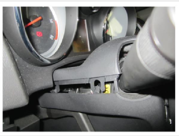
Nun wird die Verkleidung unter dem Kombiinstrument ausgebaut.
