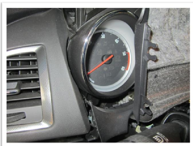
Den oberen Deckel der Tachoabdeckung vorne anheben und dann Richtung Lenkrad ziehen. Dieser ist noch mit einem Fangband fixiert, welches man losschrauben sollte (7er Steckschlüssel, gelber Pfeil), damit man den Deckel beiseitelegen kann.
