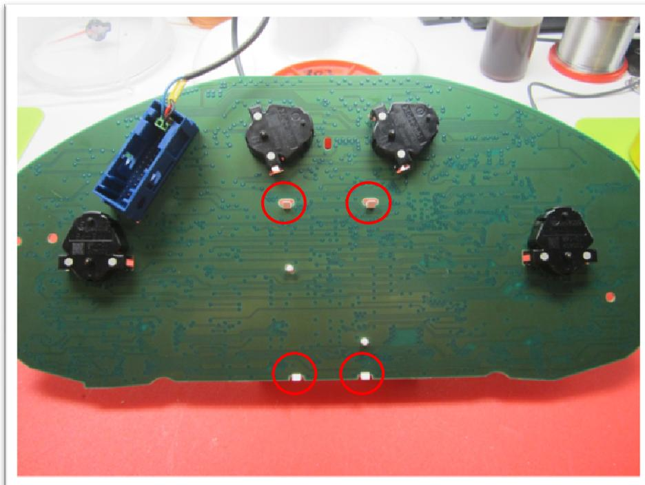
Das LCD wird mit einem Kabel an der Platine angeschlossen. Um besser arbeiten zu können sollte man das Kabel entfernen. Dazu mit einer Pinzette oder einem kleinen Schlitzschraubendreher den Connector nach oben öffnen und das Kabel entfernen.
