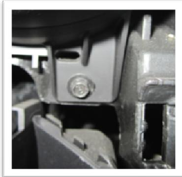
Das Kombiinstrument wird nun nur noch durch 2 Schrauben und einem Plastikhalter gehalten. Beide Schrauben (rechts und links) mit einem 7er Steckschlüssel etc. herausdrehen.
