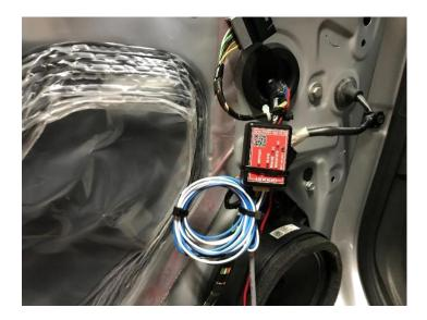
Spiegelmodul befestigen und Kabel mit Modul verbinden
