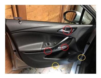
Die roten Kreise zeigen die versteckten Schrauben und die gelben Kreise zeigen die sichtbaren Schrauben.
