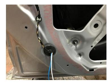
Kabel durch die Gummiabdichtung verlegen.
