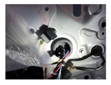
Schutzfolie unten entfernen und nach oben klappen, Kabel durch die Gummiabdichtung in das Innere der Tür verlegen.
