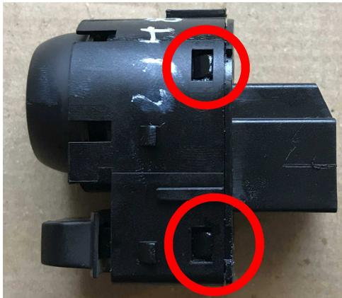
Zum öffnen des Schalters müssen die kleinen Nasen ausgeclipst werden (roter Kreis), auf jeder Seite befinden sich zwei davon. Nach dem ausclipsen die beiden Teile auseinanderziehen.
