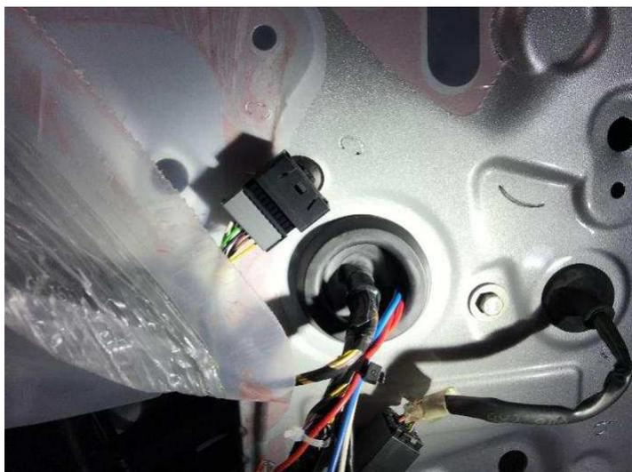
Schutzfolie unten entfernen und nach oben klappen, Kabel durch die Gummiabdichtung in das Innere der Tür verlegen.
