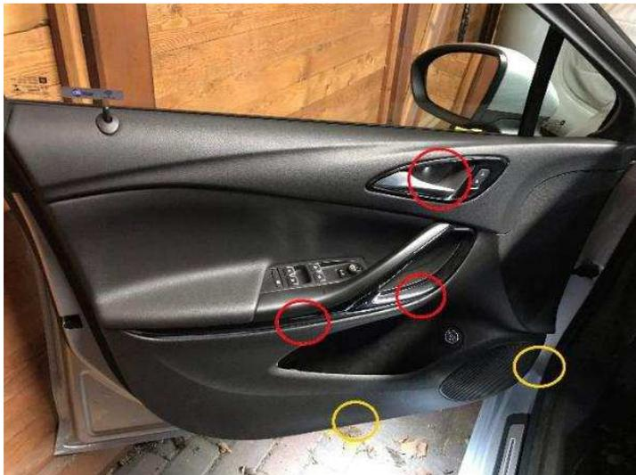
Die roten Kreise zeigen die versteckten Schrauben und die gelben Kreise zeigen die sichtbaren Schrauben.
