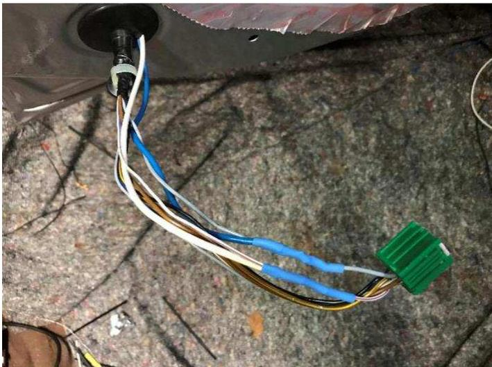
Das blaue Kabel vom Modul wird an das dicke graue Kabel Türstecker angelötet und das weiße Kabel vom Modul wird an das weiß/lila Kabel vom Türstecker angelötet. Lötstelle isolieren und den Kabelstrang wieder mit Gewebeklebeband umwickeln.
