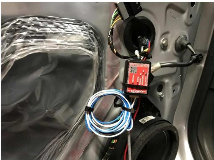
Spiegelmodul befestigen und Kabel mit Modul verbinden
