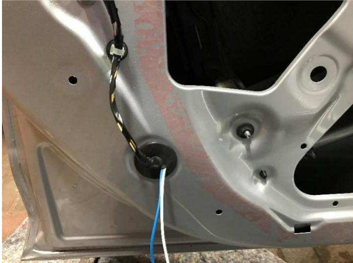
Kabel durch die Gummiabdichtung verlegen.
