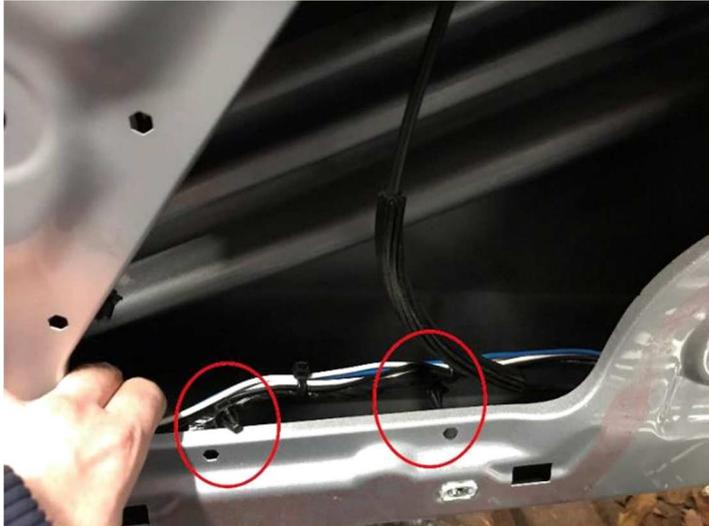
Kabelbaum ausclipsen (rote Kreise) und das neue Kabel an dem vorhandenen Kabelbaum befestigen.
