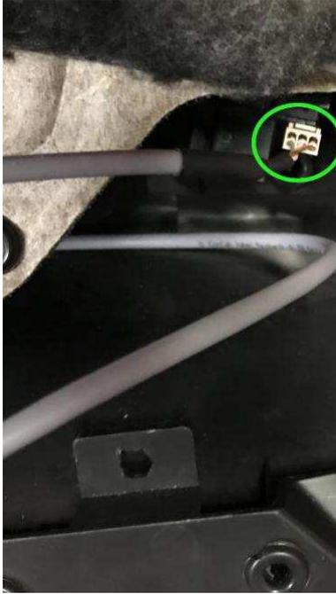
Stecker am Spiegelschalter anstecken und Funktionsprobe. Wenn alles funktioniert kann die Türverkleidung wieder montiert werden.
