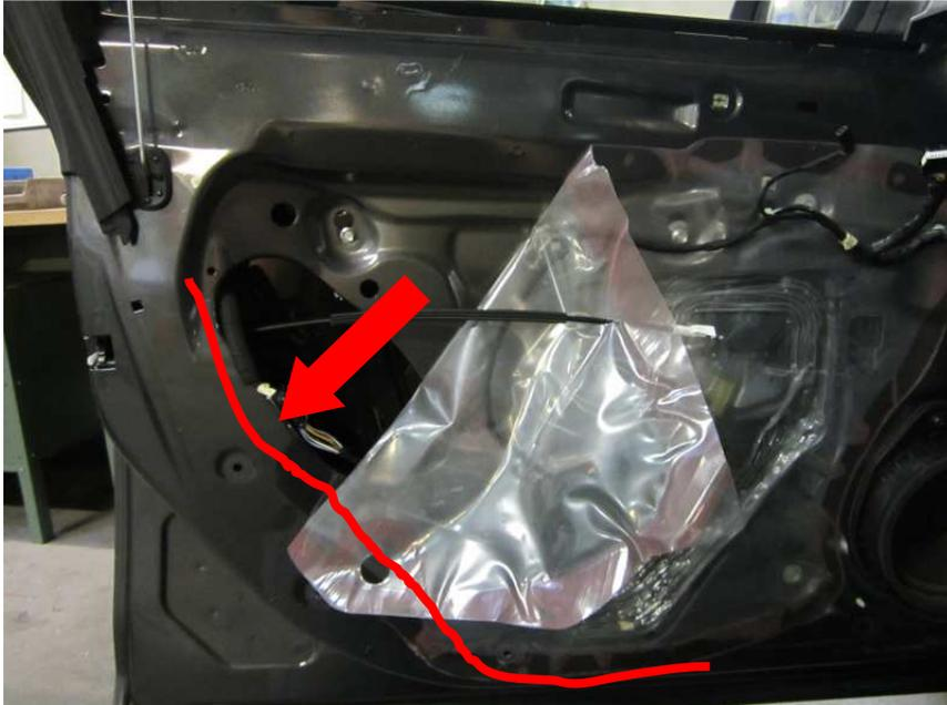
Die benötigte Leitung liegt unmittelbar hinter dem Falz der Öffnung in der Tür (roter Pfeil) und hat in etwa den Verlauf, welcher durch die rote Linie dargestellt wird.
