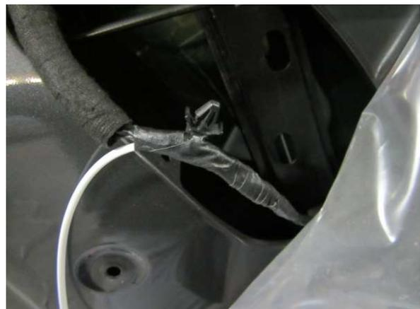
Die beiden zusätzlichen Leitungen werden an den Außenmantel des Bowdenzugs der Türverriegelung fest geklebt und auch dort aus der Folie herausgeführt, damit kein neues Loch in die Folie geschnitten werden muss.
