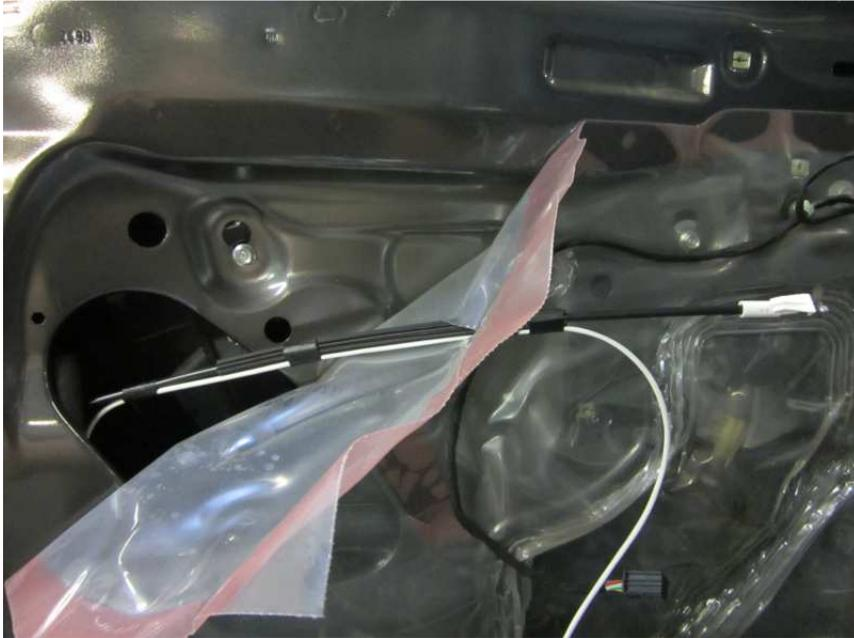
Die Folie wieder fest auf die Tür kleben und die neuen Leitungen mit an das Kabel der Fensterheber Bedieneinheit kleben:
