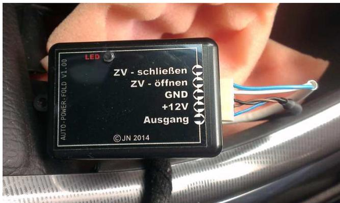
An den neuen Stecker wird nun das AutoPowerFold Modul gesteckt. Ich habe es in ein bisschen Schaumstoff gehüllt und einfach mit in das Fach unter der Fensterheber-Bedieneinheit gesteckt. Da stört es nicht und man kann es bei Bedarf in ein paar Sekunden herausnehmen.
